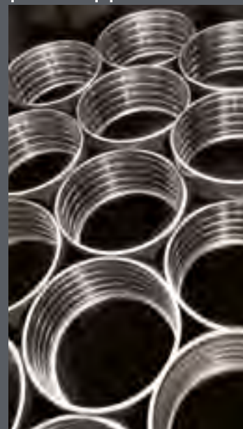
Бурильные и обсадные трубы
